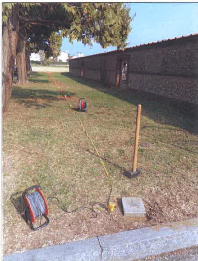
**FIG. 10** Esecuzione stendimento sismico LSI
